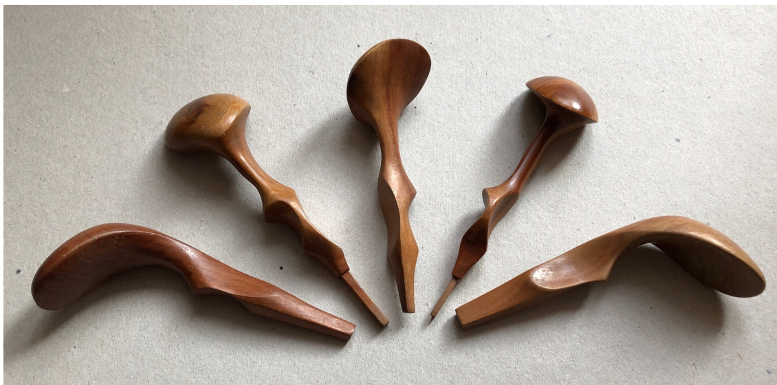
Obrázek 547, Rukojeti anatomicky řešených ryteckých nástrojů, patent Václava Šlapáka (archiv autorky)
